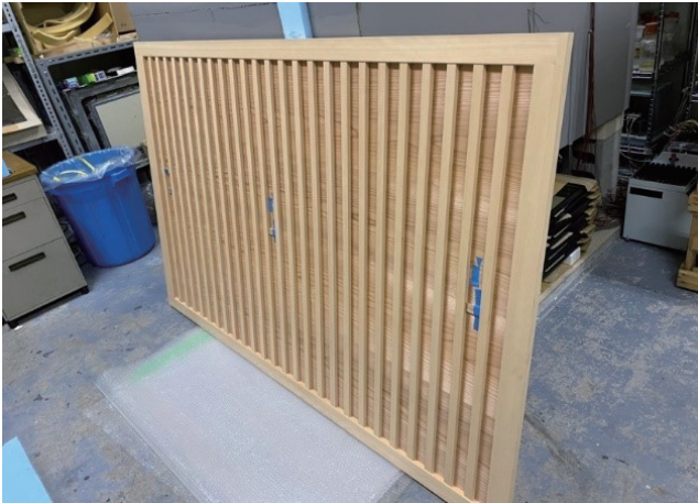
写真 4 養生室での試験体の保管状況
